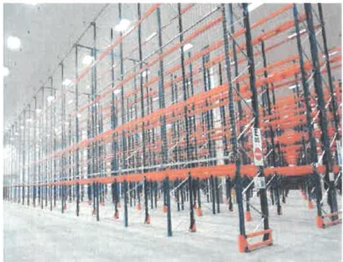
Protection de face arrière par filets
