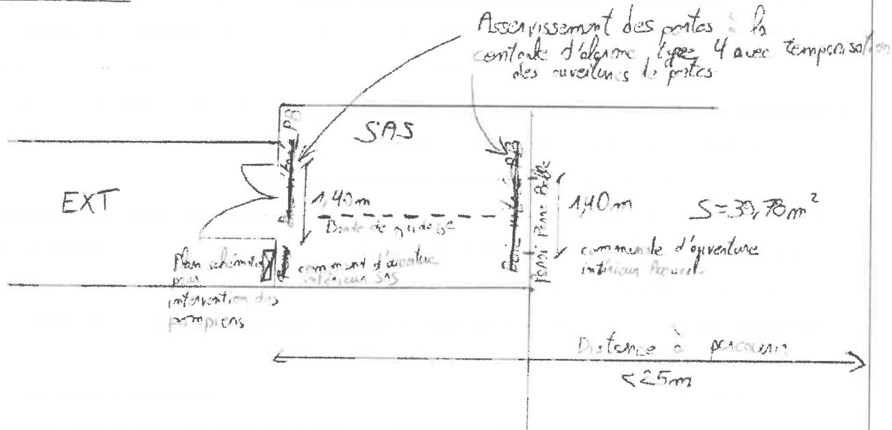
Dans le cadre de la sécurisation du SAS, il conviendra de remplacer la première baie vitrée par une (~~trois vitrées~~) portes résistant à des calibres 7.62 x 51 à moyau dur avec une porte avec 1,90 m de passage libre (avec une distance à parcourir inférieure à 25m). La seconde porte du SAS devra également être résistant (classe FB 7) à un calibre de classe FB 7.
