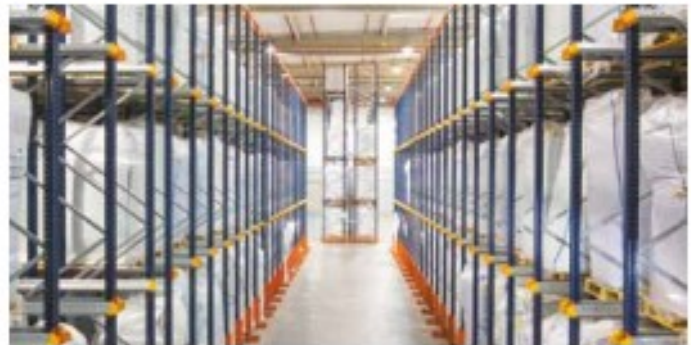
Stockage par accumulation de big-bags sur palettes
