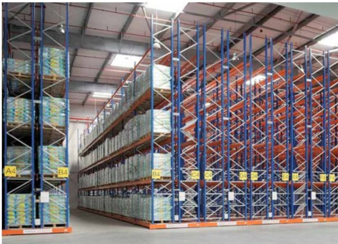
Installation de stockage à rayonnages mobiles
