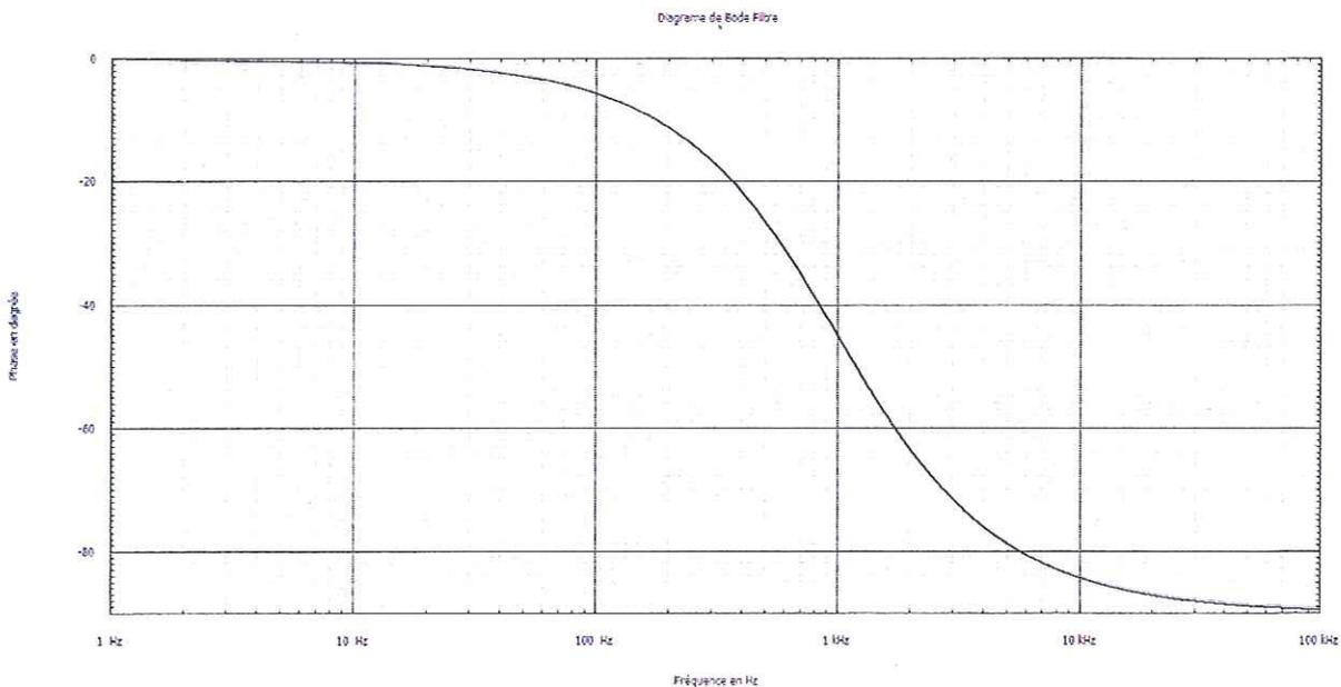
3. En utilisant le graphique ci-dessus, déterminer approximativement quelles sont les déphasages apportés par ce filtre à une fréquence de 100 Hz, 1 kHz et 100 kHz ?
