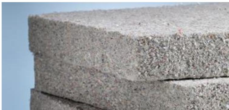
La ouate de cellulose est un matériau utilisé dans la construction. Il est classé M1, non inflammable, au titre de la classification française et B-s2-d0 au titre la classification Euroclasse. Cette dernière classification permet de mieux appréhender la réaction au feu, le mécanisme d'inflammation et de propagation de cette matière :
