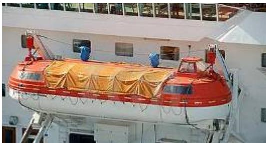
*Canot de sauvetage partiellement fermé*
