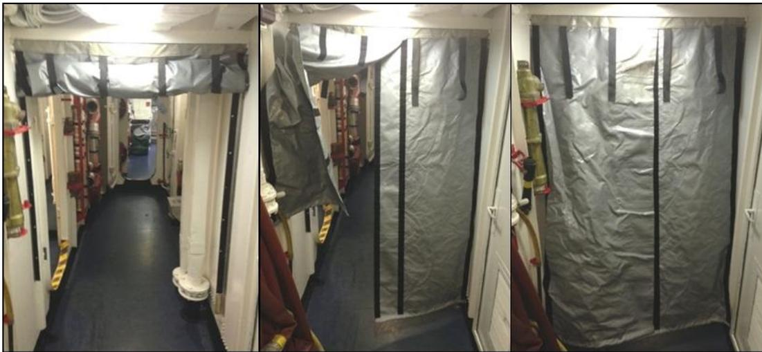
Ils servent également à réaliser un confinement au niveau des panneaux de descente (également dénommés panneaux de ponts) ne pouvant être fermés.
