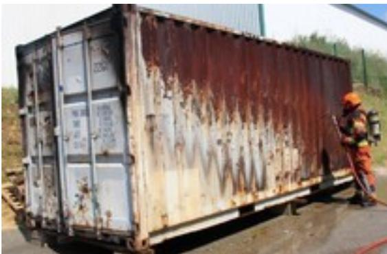
Ils existent deux types de lances : à perçage manuel ou hydraulique. Ces types de lances agissent par « étouffement » d'un volume clos (compartiment, container). Outre l'action extinctrice, elles permettent d'éviter l'apparition d'un éventuel phénomène thermique et ainsi d'améliorer le niveau de sécurité des personnels intervenants.
