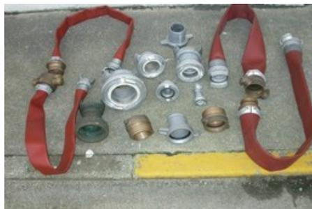
Pour pouvoir utiliser le collecteur incendie du bord avec le matériel des services de secours, il est nécessaire de pouvoir se raccorder sur les bouches d'alimentation. L'incompatibilité des différents raccords impose de disposer de différents types de raccords internationaux.
