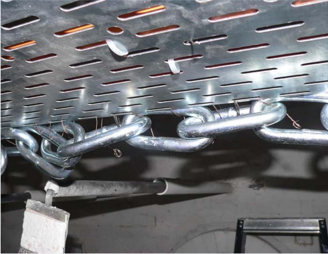
Photographie 5 : Détail de fixation des chaînes et thermocouple type plat
